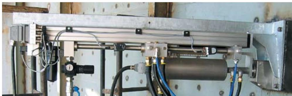
4 Feuerraumsensor mit Rückzugseinheit (Luft und Wasser gekühlt)
