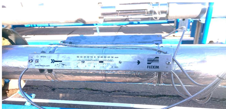
Obr. 5 Osadenie ultrazvukových senzorov na potrubie.
